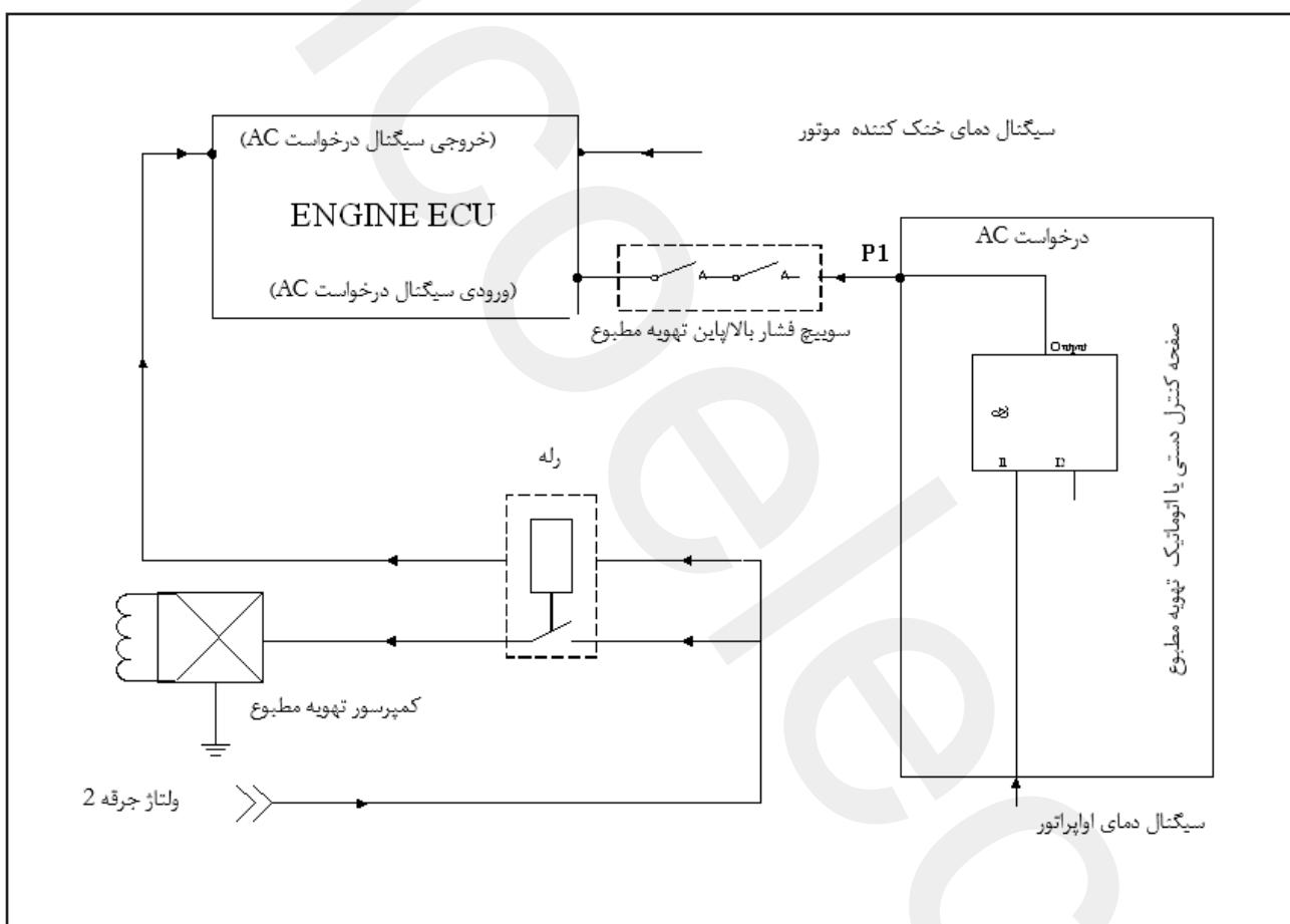
وقتی تمام بخش‌های سیستم‌های تهویه مطبوع دستی و خودکار به طور عادی کار می‌کنند سه شرط لازم برای درگیر شدن کمپرسور وجود دارد درگیری کمپرسور تنها در صورت وجود این سه شرط اتفاق می‌افتد. جزئیات در ذیل آمده است.
