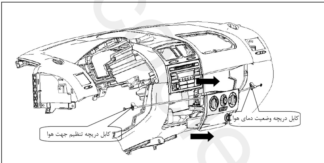
(۱) کابل دریچه تنظیم جهت هوا را از مجموعه بخاری جدا کنید.
