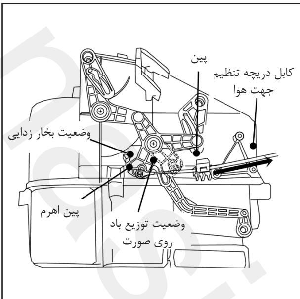
۲. مراحل نصب کابل دریچه هوای مجموعه
