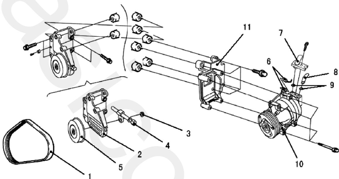
۲. مراحل باز کردن پولی و براکت تسمه سفت کن:
